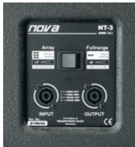
NT-3: Die NT-3 lassen sich von Array auf Fullrange-Betrieb umstellen.
